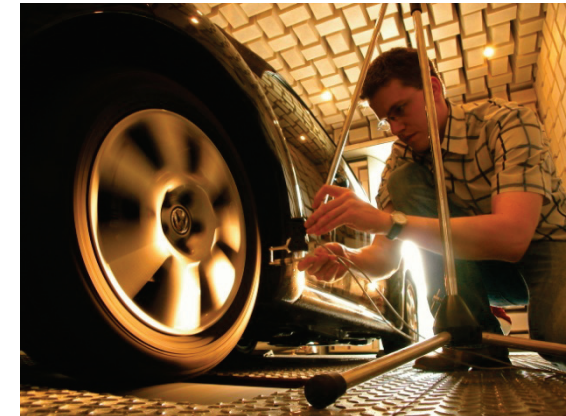
Messung von Reifengeräuschen im Schallmesshaus
