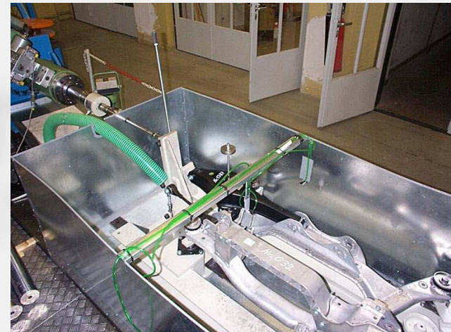
Komponentenprüfstand mit Umfeldsimulation (Korrosion)
